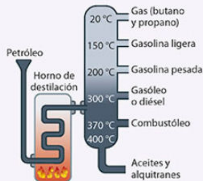
Figura 1.13. Conocer el punto de ebullición de las sustancias permite separar algunos de los productos del petróleo, ya que la temperatura de ebullición es diferente para cada uno.
