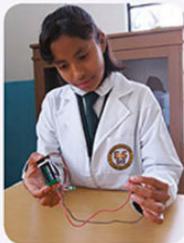
Figura 2.26. Una vez armado el circuito eléctrico comprueba que funciona uniendo los dos extremos, debe prender el foco LED.
