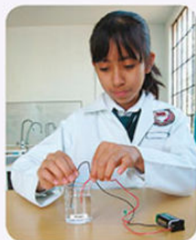
Figura 4.10. Recuerda que para que funcione el circuito debes quitar, con la lija, la capa que recubre el cobre en cada sección que se conecta a la pila y al foco, así como en los extremos libres.
