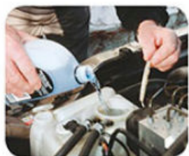
Figura 1.25. Al añadir una disolución (anticongelante) al depósito refrigerante del automóvil, se logra que descienda el punto de solidificación y el auto puede funcionar sin problemas gracias a esta propiedad de las disoluciones.
