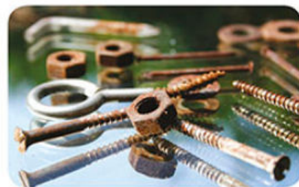
Figura 3.5. La transformación del hierro en óxido de hierro III ( Fe_2O_3 ) es un cambio químico, se produce al unirse químicamente el hierro con el oxígeno del ambiente.
