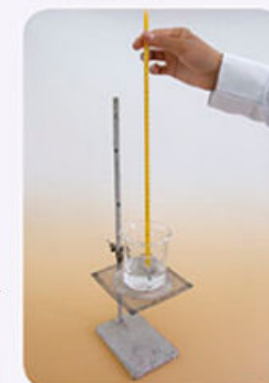
Figura 1.12. El termómetro debe tocar únicamente la sustancia a la que se desea medir la temperatura, sin hacer contacto con el recipiente.
