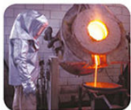
Figura 4.21. La industria metalúrgica usa hornos para fundir y reducir minerales para la obtención de metales.
