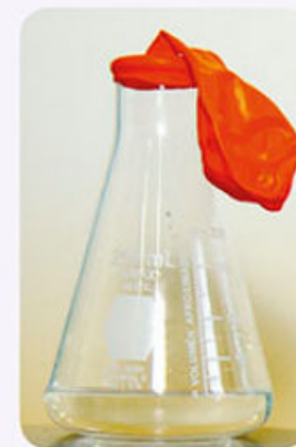
Figura 3.17. Sujeta con una liga o un hilo el globo a la boca del matraz.
