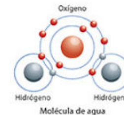
Figura 2.46. Representación de la molécula del agua. Al unirse un átomo de oxígeno con dos de hidrógeno se forman dos enlaces covalentes; en cada enlace se comparte un par de electrones.
